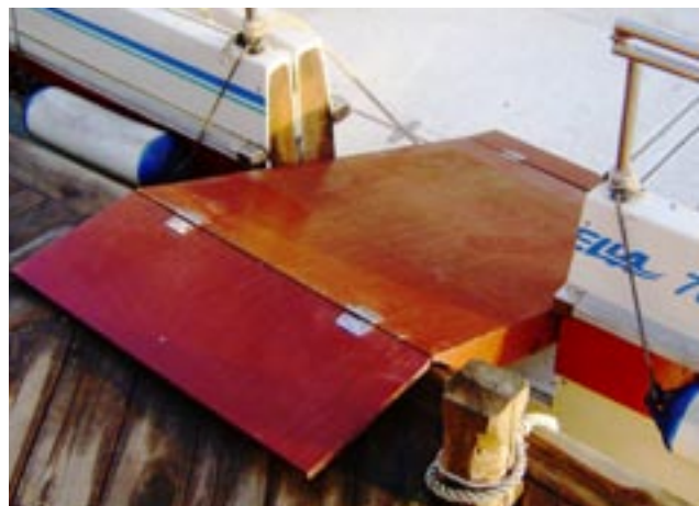
Enkel rampe i kryssfiner, konstruert slik at hengslene ikke får for stor belastning.
